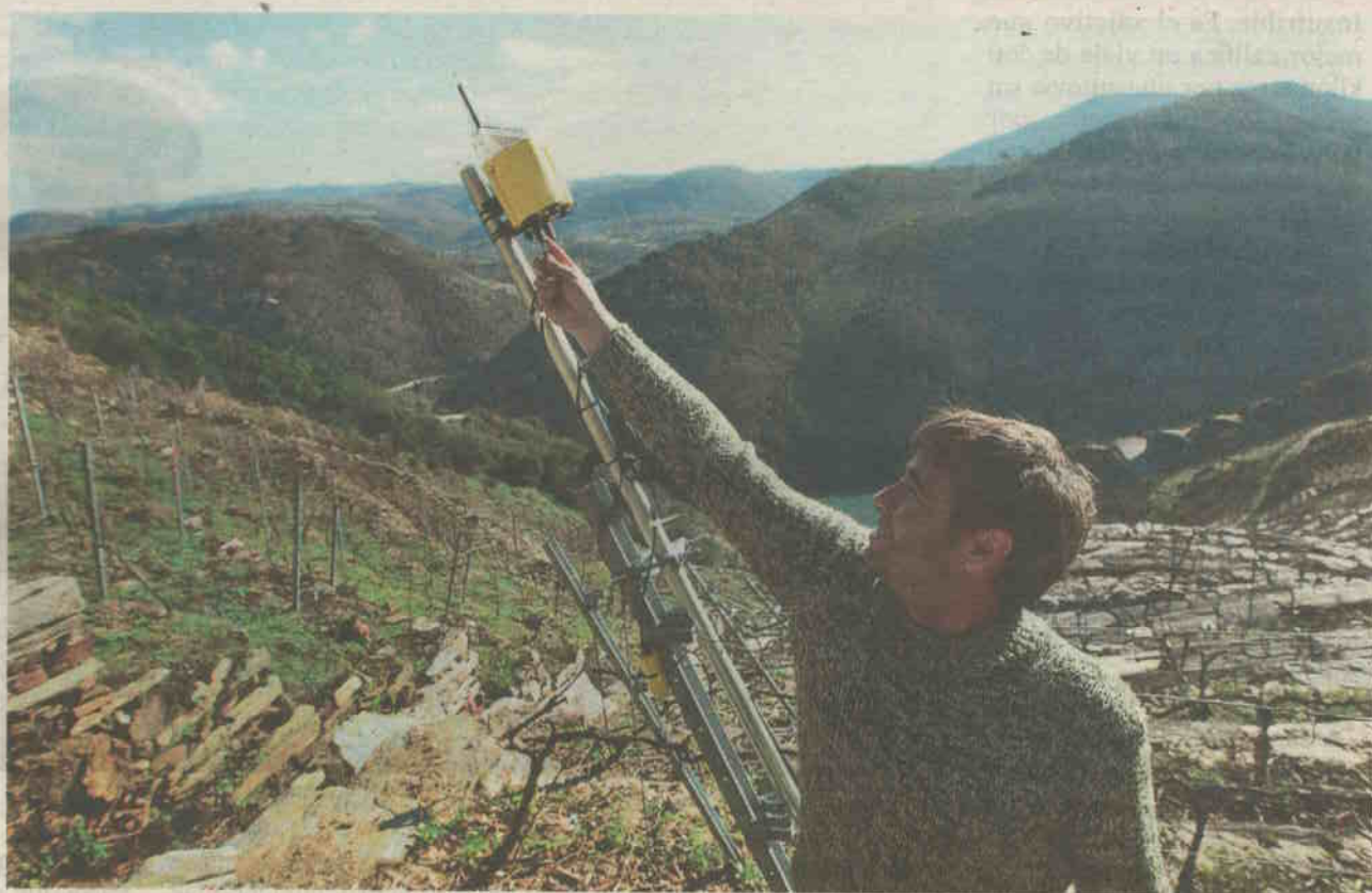
Una red de sensores sin cables ofrece información en tiempo real sobre las necesidades de las cepas. ROI FERNÁNDEZ
